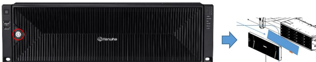
(2) ロック無しType：ロック付きType:赤い円の部分を押しとFrontCase取り外し裏面にDust Filter あり。
